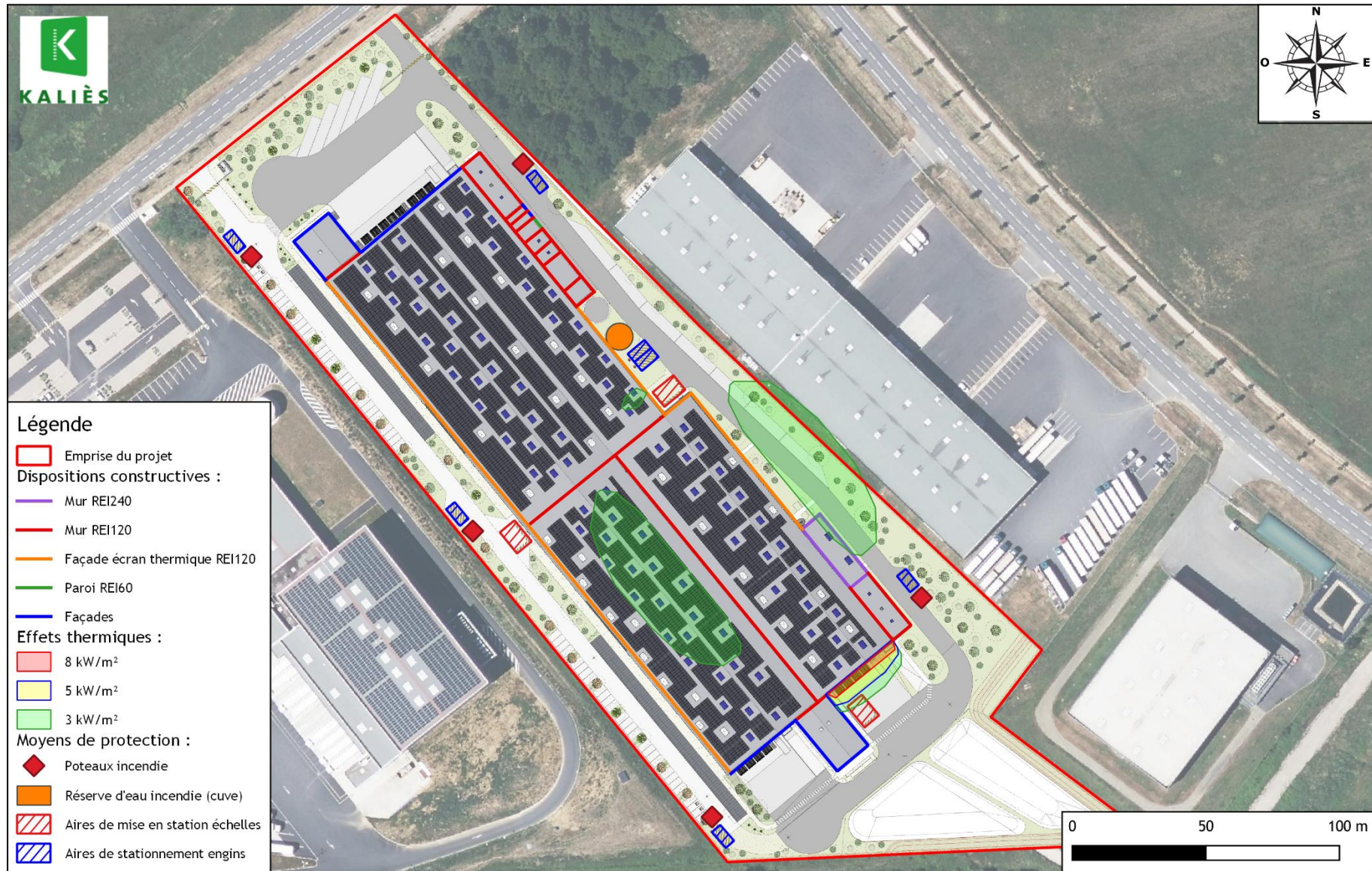
Figure 14. Effets thermiques d'un incendie 1510 dans la cellule 2
