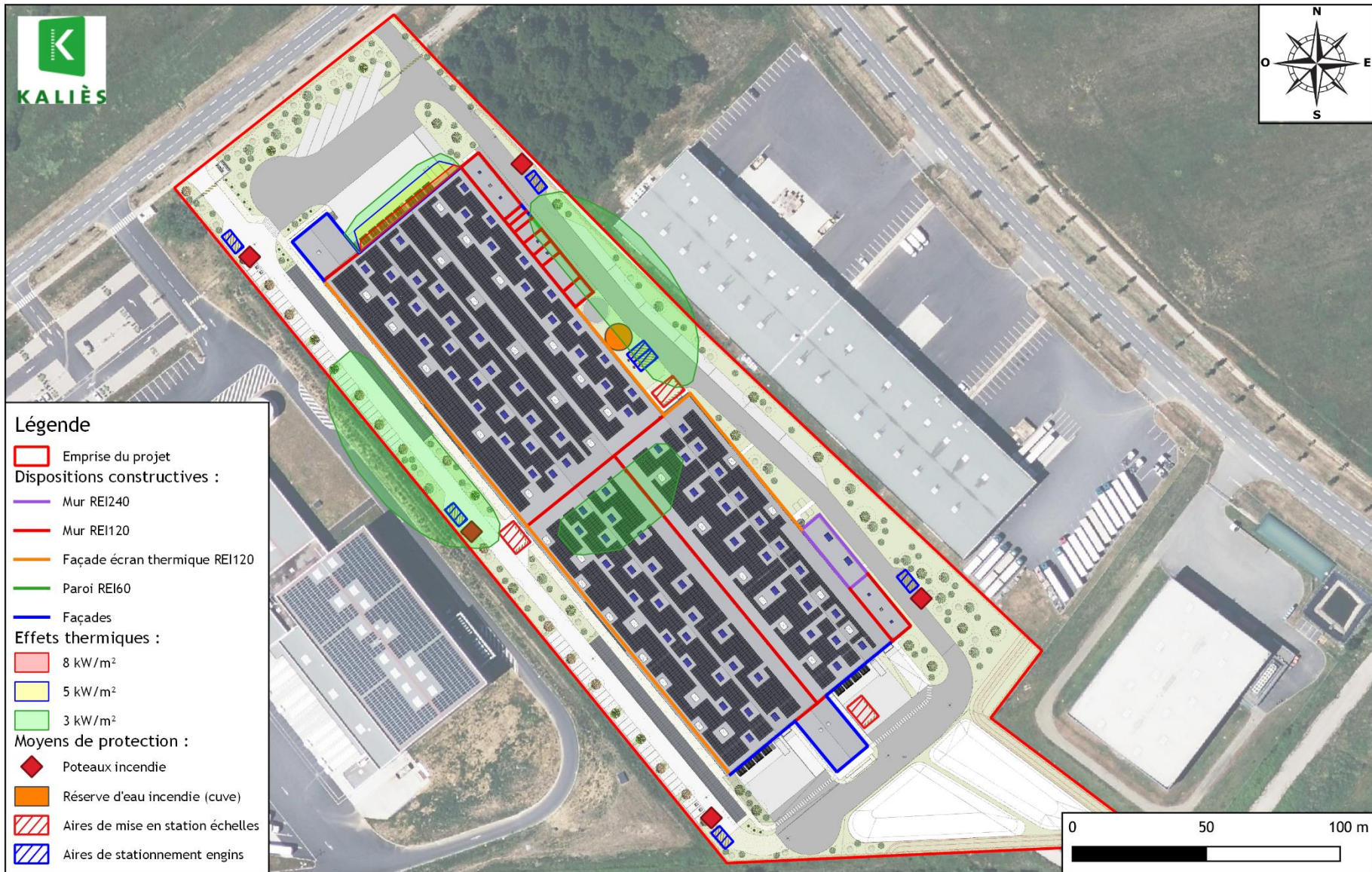
Figure 7. Effets thermiques d'un incendie 1510 dans la cellule 1
