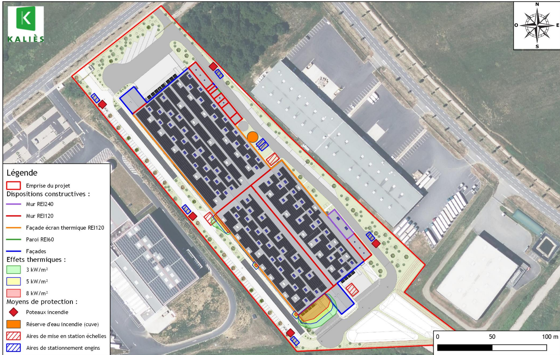
Figure 24. Effets thermiques de l'explosion du stockage d'aérosols dans la cellule 3
