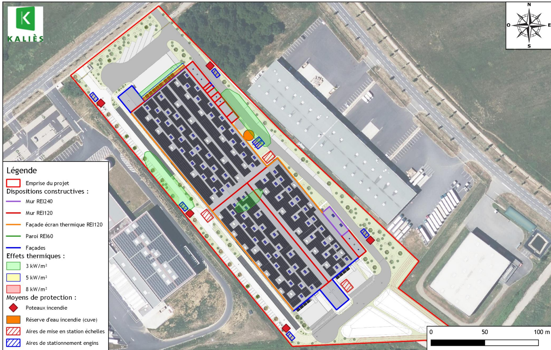
Figure 8. Effets thermiques d'un incendie 1511 dans la cellule 1
