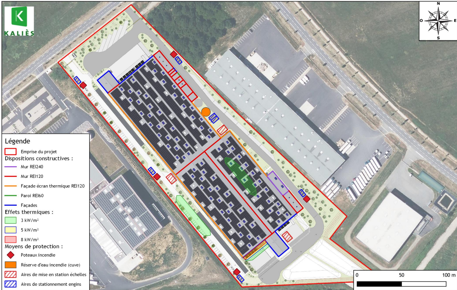
Figure 22. Effets thermiques d'un incendie 1511 dans la cellule 3
