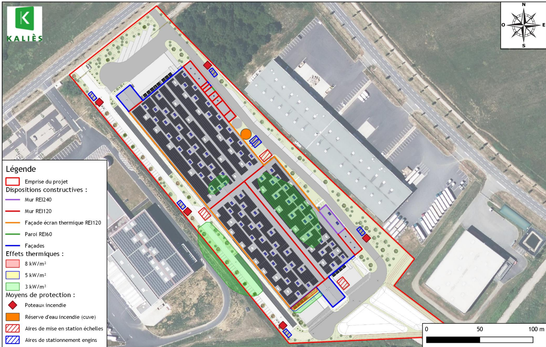
Figure 21. Effets thermiques d'un incendie 1510 dans la cellule 3
