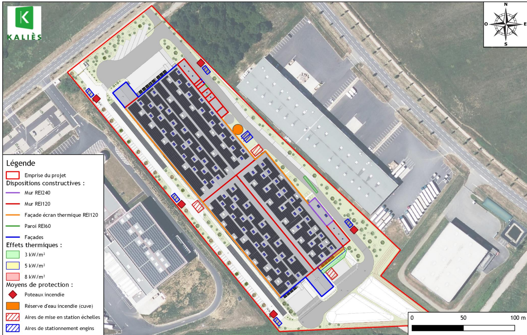
Figure 15. Effets thermiques d'un incendie 1511 dans la cellule 2
